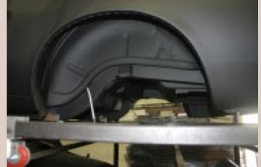
Hier ziet u het samenkomen van het achterscherm, binnenscherm en subframe aan de bestuurderskant.
