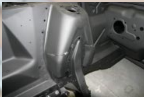
Hier ziet u de dikke big-block-type verstevigingen op de schokbreker towers zoals gebruikt op de '69-'70 modellen.
