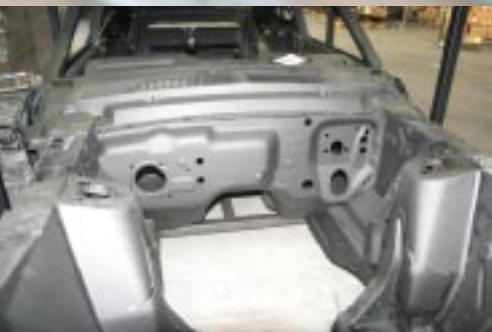
Alle gaten in het brandschot zitten op de juiste plek, zoals die voor de stuurkolom, bedrading, kachelslangen en hoofdremcilinder.
