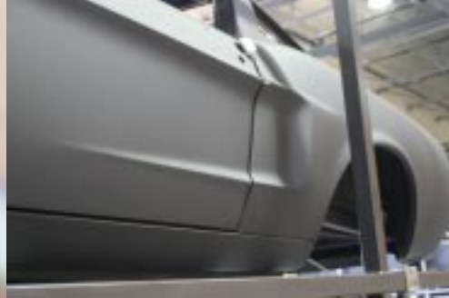
Hier ziet u het '68 achterscherm. Verkrijgbaar op speciale bestelling en het enige verschil tussen de Dynacorn '68 en '67 body's.
