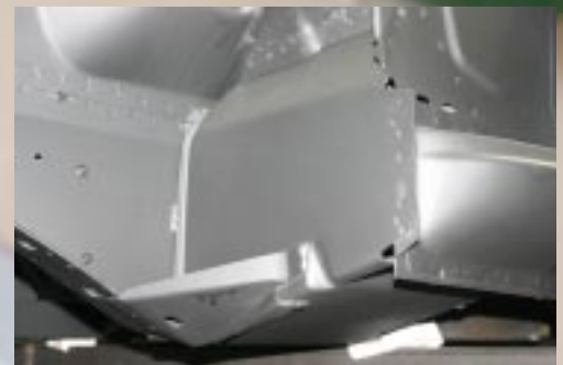
Convertible-stijl torque boxes zijn ook standaard op de Dynacorn body's.
