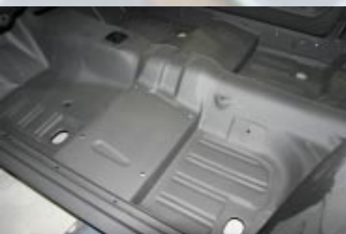
Geen interesse in het monteren van nieuwe vloerdelen in een roestige '67 of '68 Mustang? De nieuwe vloerdelen in een Dynacorn body zien er schitterend uit. Let op het stoelplatform uit één stuk.
