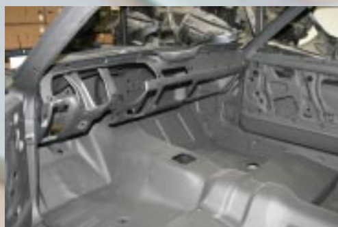
Het dashboard is gemonteerd en klaar voor alle elektrische delen, meters en bekleding.
