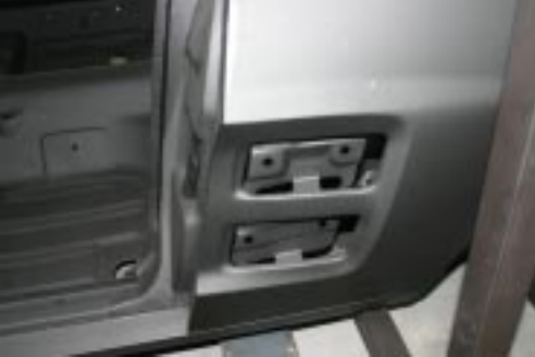
Het rechterachterscherm toont de opengewerkte plekken voor de '67 nepinlaten. De meeste body's zullen op deze wijze worden gebouwd.
