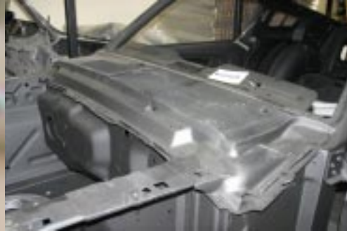
Een plek die zeer roestgevoelig is op originele body's, de cowl op the Dynacorn body heeft de juiste opening en gaten, zoals voor de ruitenwissers.
