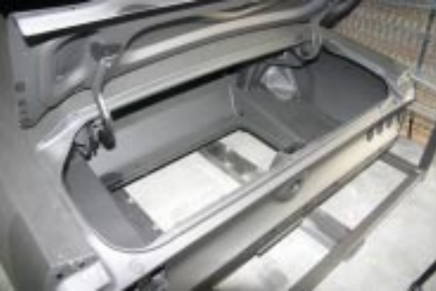
De kofferbak is compleet en klaar voor de 16- ('67-'68), 20- ('69), of 22-gallon ('70) benzinetank of een race benzinetank. Het kan allemaal.
